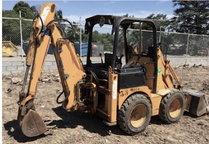
Fig 1.1. Mini backhoe loader
