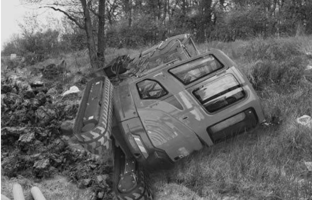
Fig 1.2. Mini excavator overturn [3]
