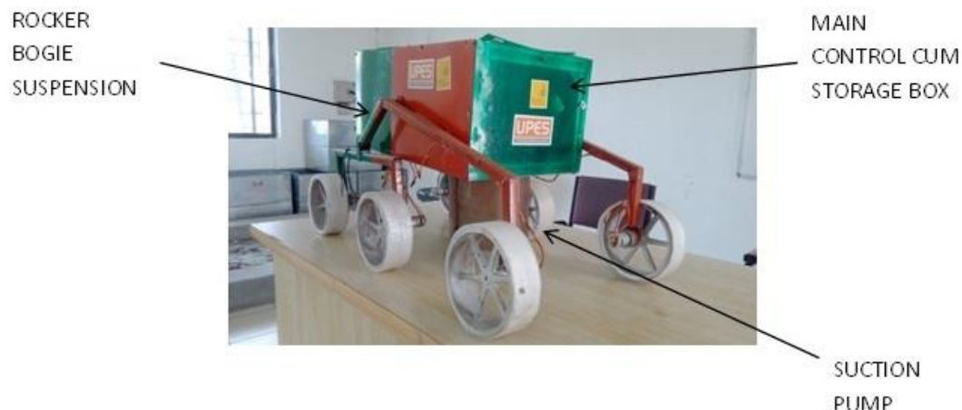
Fig. 3.12: Actual Structure of PiNCoR
